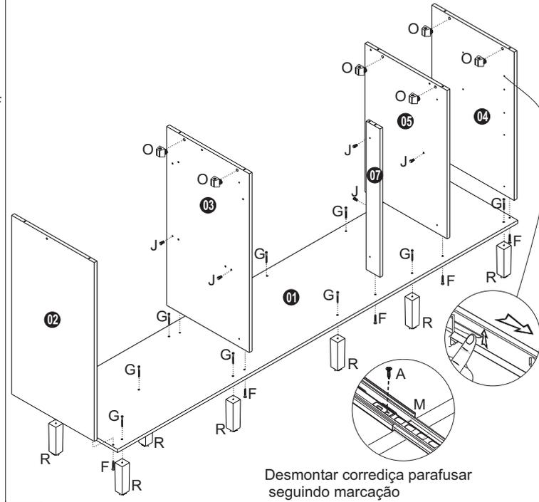
**3º** Unir módulo inferior ao módulo superior do armário, primeiro parafusar tampo 6 na lateral 3 em seguida coloque módulo superior sobre módulo inferior, parafusar de baixo para cima tampo 6 nas peças 18 e 19, use trapézio O e parafuso C para unir módulos.
