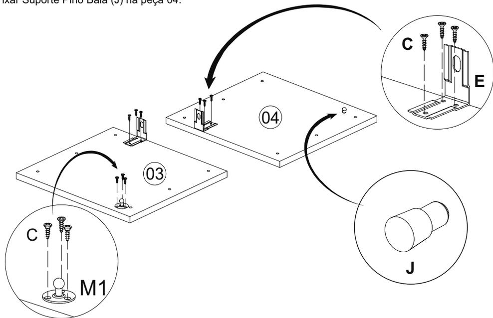
**Passo 3:** Fixar peça 03 e 04 nas peças 01 e 02 com o parafuso 5x40 (B).
